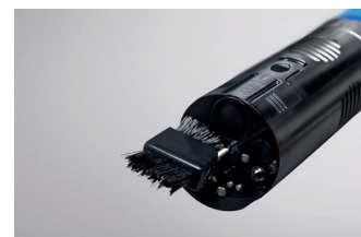
Système de balai-brosse anti-fouling (en option) qui protège et nettoie tous les capteurs, y compris la conductivité
