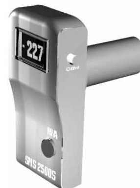
CAPTEUR à DEPLACER de TENSIOMETRE en TENSIOMETRE
