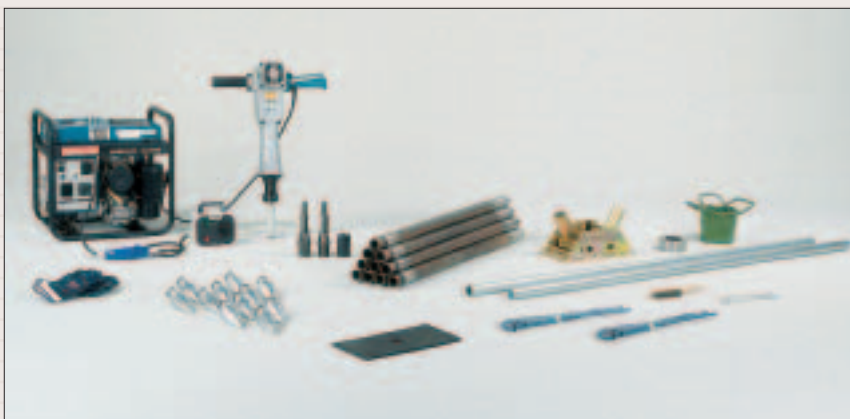
Ensemble de perforation à cônes perdus
